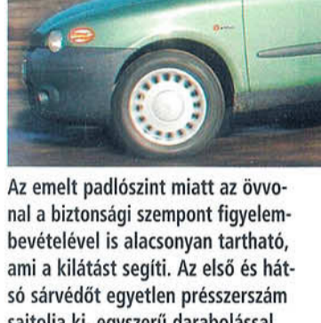
Az emelt padlószint miatt az övönal és a biztonsági szempont figyelembevételével is alacsonyan tartható, ami a látást segíti. Az első és hátsó sárvédőt egyetlen présrészszámból sájtja ki, egyszerű darabolással választják szét őket. A „konfliktus” az érzelmek hat
