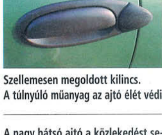
Szellemesen megoldott kilincs. A túlnyúló műanyag az ajtó élét védi
